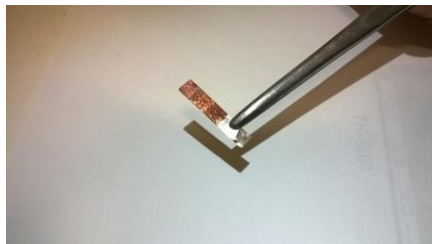
Figura 23 a,b,c,d,e : ingrandimenti elettrodo Pt. Soluzione FeLa1 (0,15M) -30mA/cm^2 per 250s
